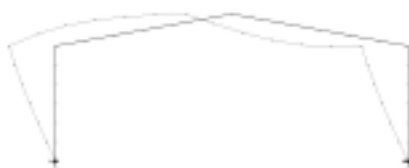
Rys. 3. Pierwsza postać wybożeniowa ramy portalowej z rygłem pełnościennym
